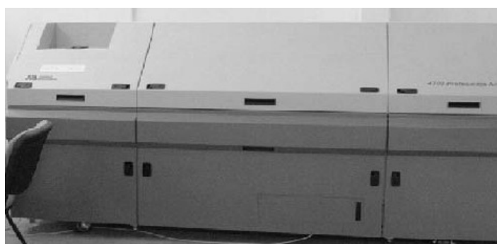
Figura 3. (A) Descrizione di un nuovo apparecchio per fare l'analisi delle sostanze organiche; (B) Sistema MALDI-TOF/TOF per l'analisi delle sostanze organiche.
